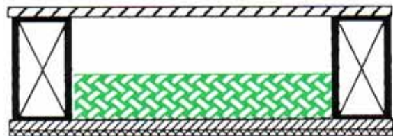
25 mm dicke Holzspanplatten auf Holzbalken, unterseitige Verkleidung aus Span- oder Gipskartonplatten über Holzleisten direkt am Balken befestigt. Im Hohlraum 50 mm Mineralfaserfilz (ca. 40 kg/m 3 )
